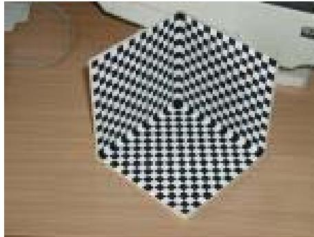
Figura 14: Plataforma de Calibração
