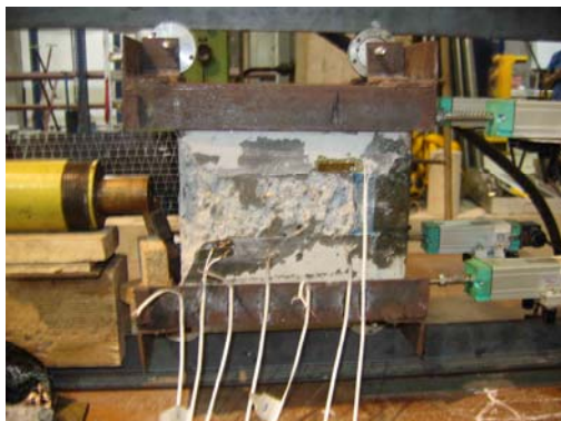
Figura 4.8 – Ruptura por arrancamento do substrato de concreto do corpo-de-prova L50-R45-2; detalhe do arrancamento.
