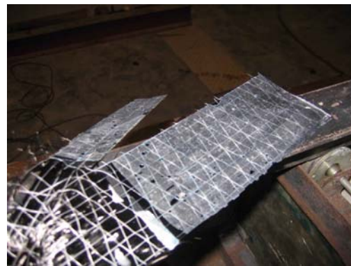
Figura 4.11 – Ruptura por descolamento do tecido com arrancamento do concreto no início da ancoragem do corpo-de-prova L100-R45; detalhe do descolamento com rompimento do tecido.
