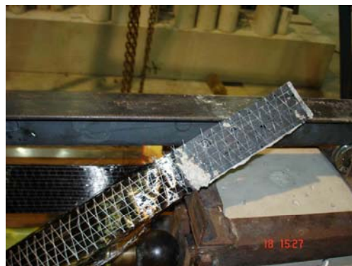
Figura 4.5 – Detalhe do descolamento do tecido do corpo-de-prova L50-R35-1.
