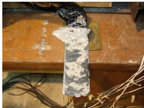
Figura 4.8 – Ruptura por arrancamento do substrato de concreto do corpo-de-prova L50-R45-2; detalhe do arrancamento.
