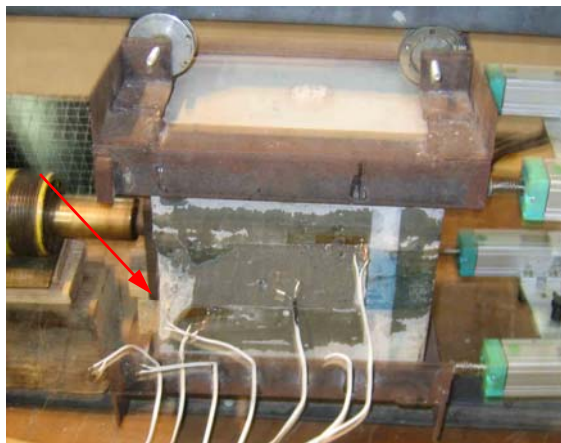
Figura 4.7 – Ruptura por descolamento do tecido com arrancamento do concreto no início da ancoragem do corpo-de-prova L50-R45-1.
