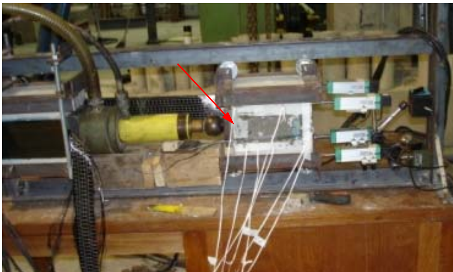
Figura 4.4 – Ruptura por descolamento do tecido com arrancamento do concreto no início da ancoragem do corpo-de-prova L50-R35-1.
