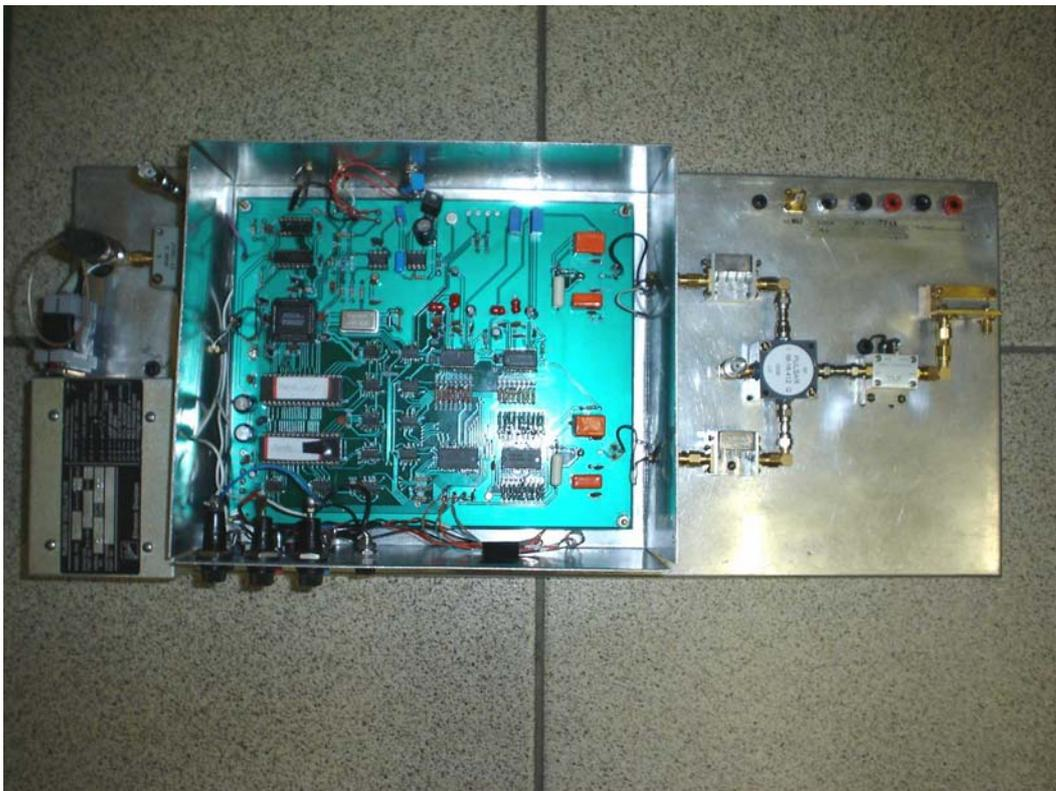
Figura 14 - Sistema Transmissor Desenvolvido
