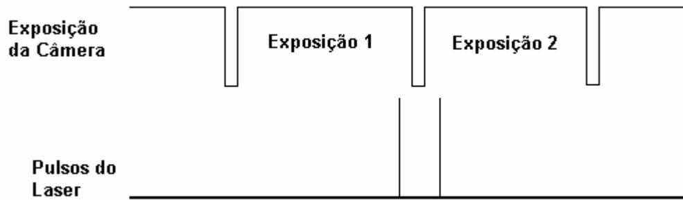
Figura 4.1 – Diagrama de sincronismo utilizado na aquisição de imagens com PIV
