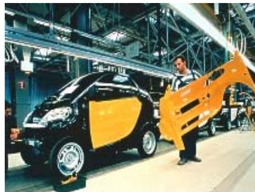
Figura 3b: montagem dos painéis coloridos no Smart
