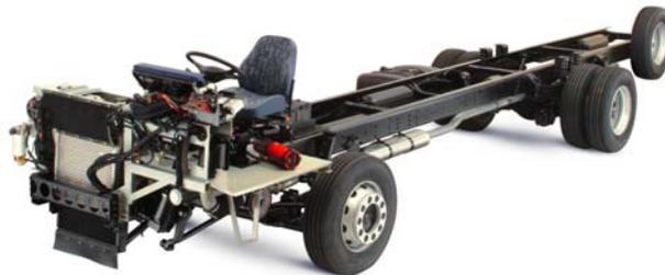
Figura 5: Sistema de componente completo de um ônibus
