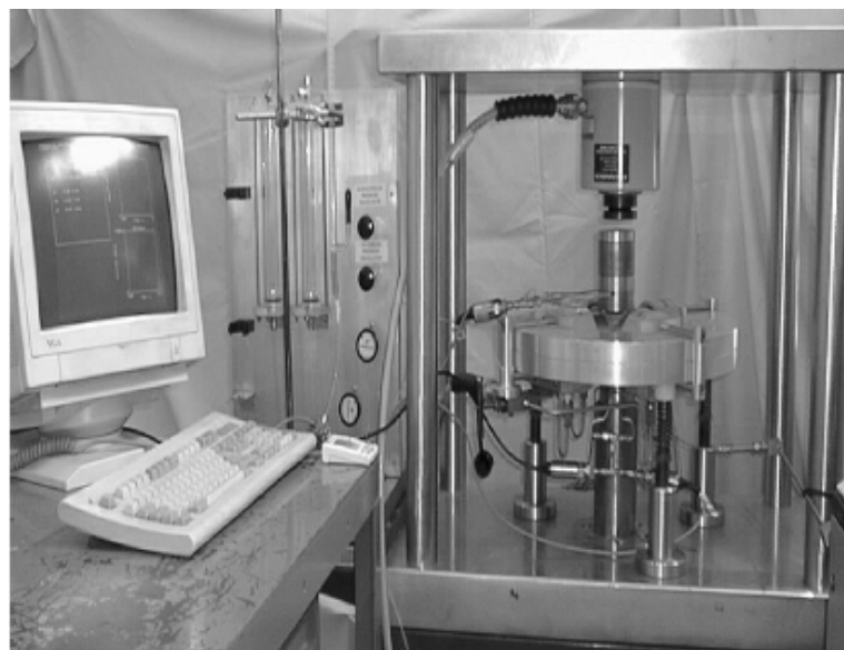
Figura 2.27 – Foto do sistema de carregamento triaxial verdadeiro depois de King et al. , 1995 (Al-Harthy et al. , 1998a)
