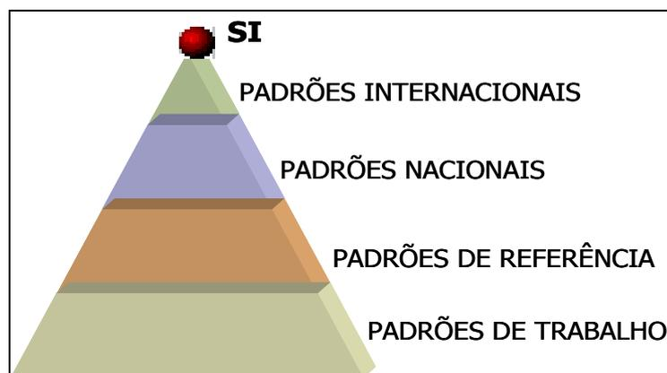
Figura 6 – Estrutura hierárquica dos padrões de medição.
