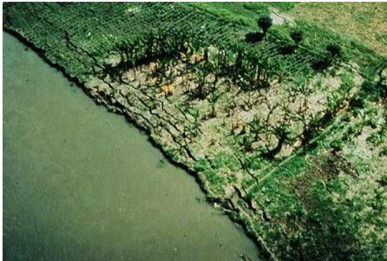
Figura 1.4 Escorregamentos laterais (*lateral spreading*) ao longo do rio Motagua, Guatemala, durante terremoto em 1976, notando-se fraturas paralelas ao rio. (Earthquake Engineering Research Center, University of California, Berkeley, USA).
