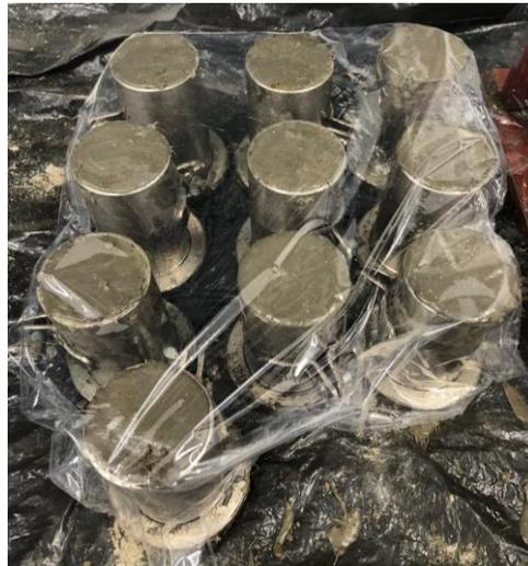
Figura 3-7 – Corpos de prova cilíndricos para o ensaio de compressão
