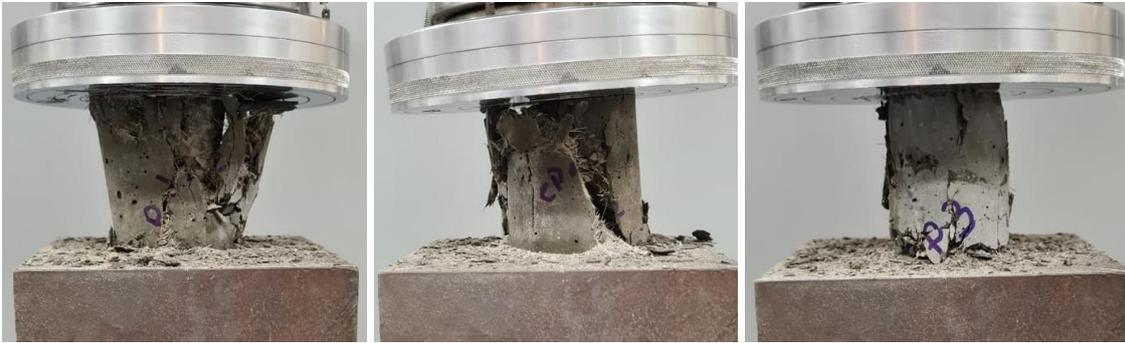
Figura 4-2 – Rompimento aos 28 dias de corpos de prova cilíndricos moldado com CUAD e 160kg/m<sup>3</sup> de fibras de aço
