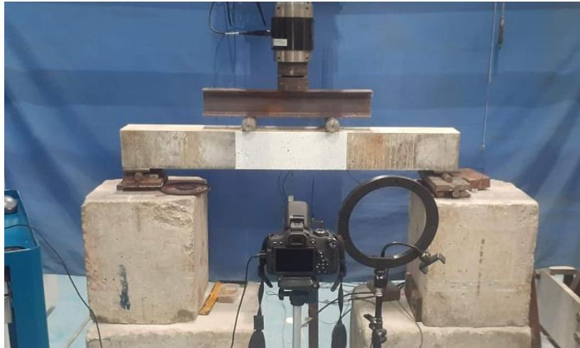
Figura 3-13 – Ensaio de flexão de quatro pontos na viga
