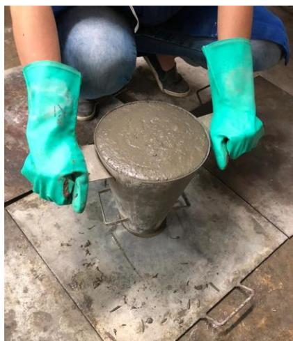
Figura 3-6 – Foto do ensaio de espalhamento
