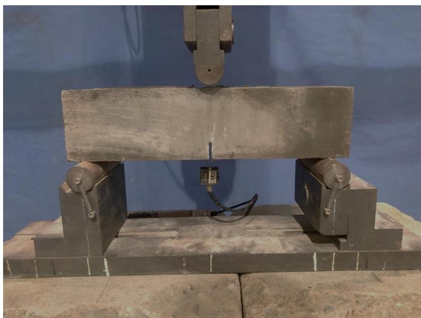
Figura 3-10 – Detalhe do ensaio de flexão em prismas
