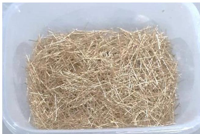
Figura 3-3 – Fibras de aço utilizadas
