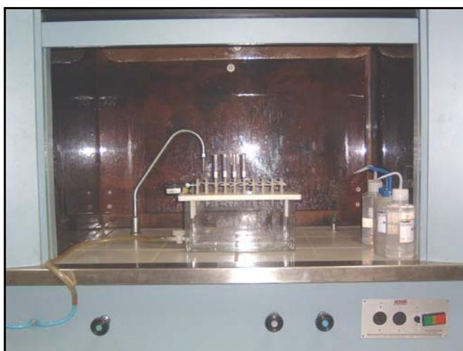
**Figura 15.** Extração por fase sólida com equipamento denominado cuba a vácuo.
