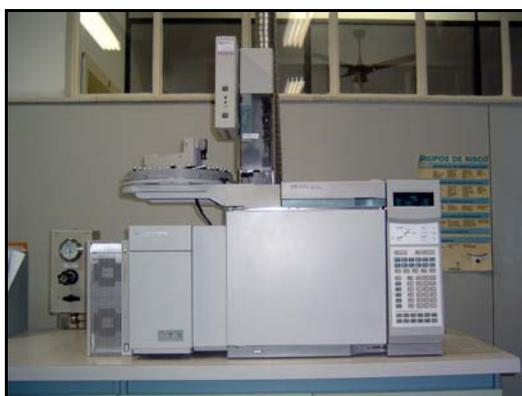
**Figura 16.** Sistema cromatógrafo a gás / espectrômetro de massas.
