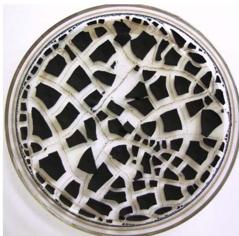
Figura 3.7 - Magnetita obtida após secagem em placa de Petri.
