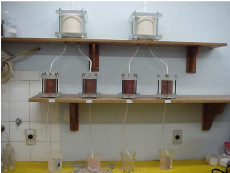
Foto 7 – Foto geral do ensaio de coluna (percolação do contaminante).
