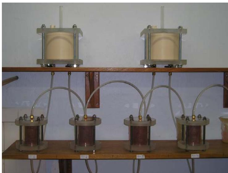
Foto 9 – Saturação das colunas com fluxo ascendente.
