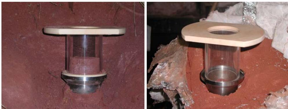
Foto 8 – Sistema de cravação dos tipos de solo, no campo e no laboratório.
