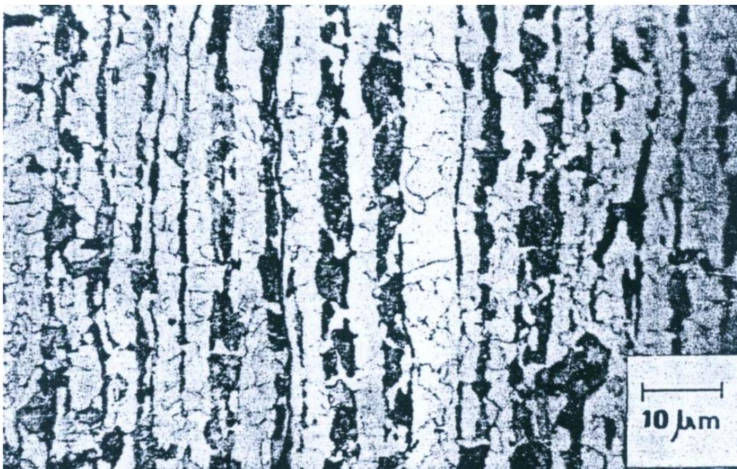
Figura 2.13- Amostra de aço com 0,21C e 0,85 Mn com bandeamento ferrita/perlita [22].
