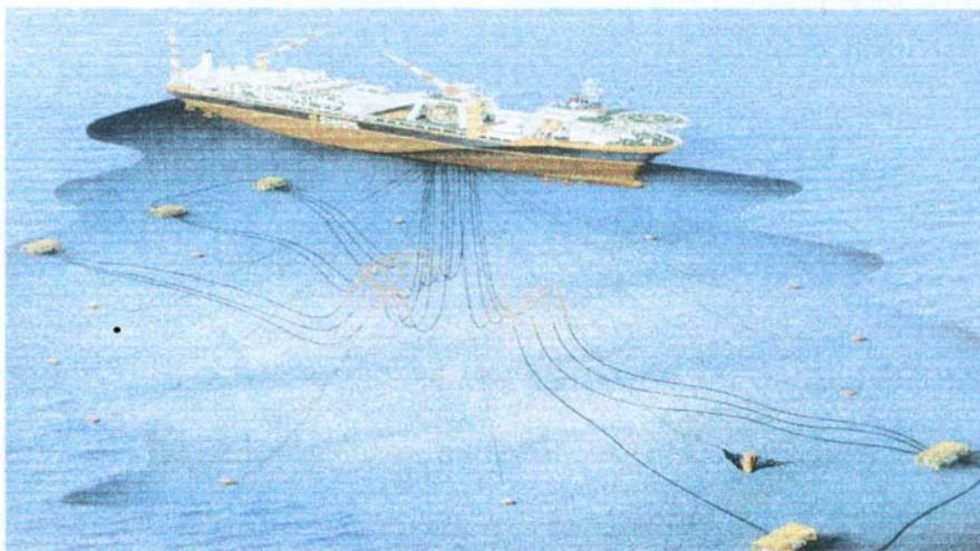
Figura 2.1- Esquema de um FPSO e seu sistema de ancoragem [7].
