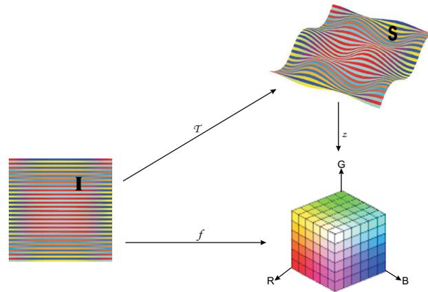
Figura 3.3: Definição de mapeamento de textura. A função  $T$  é uma transformação e a função  $z$  é o mapeamento de textura.
