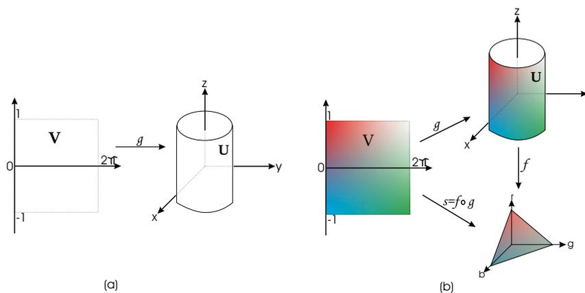
Figura 3.2: Descrição paramétrica de um cilindro. O suporte paramétrico  $V$  é definido por  $V = [0, 2\pi] \times [-1, 1]$  e a função paramétrica é  $g(x, y) = (\cos(x), \sin(x), y)$ .
