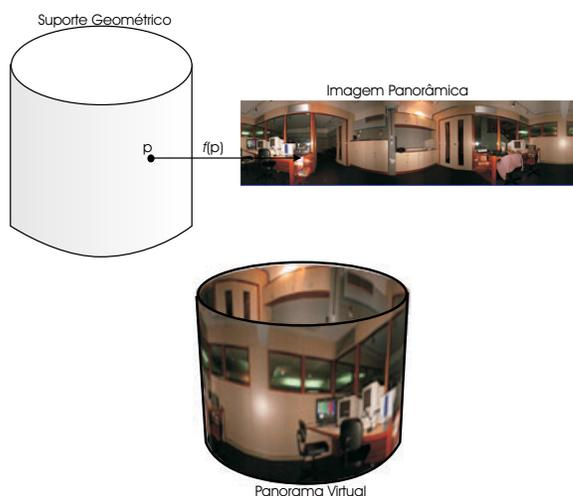
Figura 3.6: Exemplo de um mapeamento de textura em uma panorama cilíndrica.
