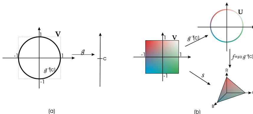
Figura 3.1: Descrição implícita de uma circunferência. Neste exemplo o suporte do objeto gráfico  $V$  é definido por  $V = [-1, 1] \times [-1, 1]$ , a função implícita é  $g(x, y) = x^2 + y^2$  e  $c = 1$ .
