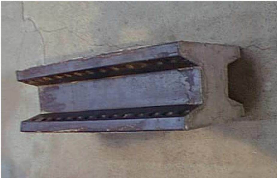
Figura 4.2 – Peças usadas nos ensaios tipo “Push out”.
