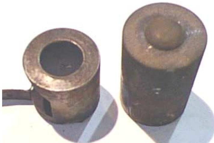
Figura 4.6 – Ferramenta tipo macho e fêmea para execução das mossas.
