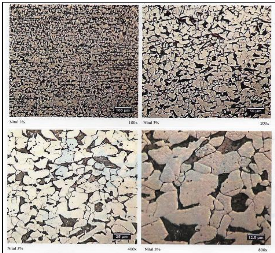
Figura 57 – Microestrutura de ferrita e perlita, com tamanho de grão ferrítico nº 9,0
