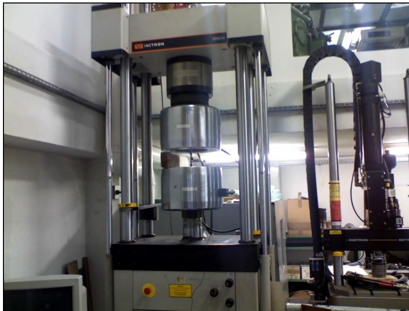
Figura 31– Máquina servo hidráulica Instron 8504 de 500kN.
