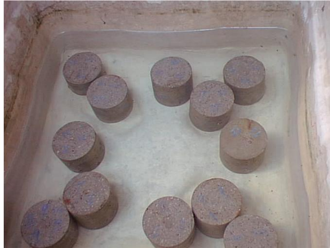
Figura 4.13 – Corpos de prova imersos em água.
