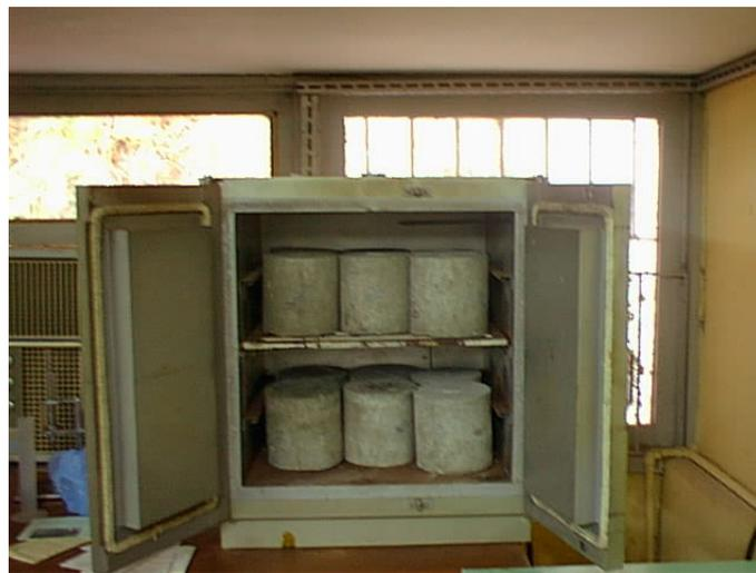
Figura 4.12 – Corpos de prova colocados na estufa.
