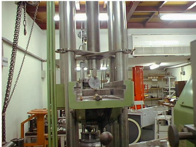
Figura 4.6 - Corpo de prova posicionado na máquina para ensaio de tração por compressão diametral.
