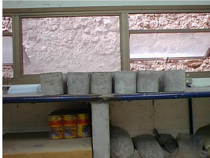
Figura 4.11 - Corpos de prova preparados para ensaio de porosidade
