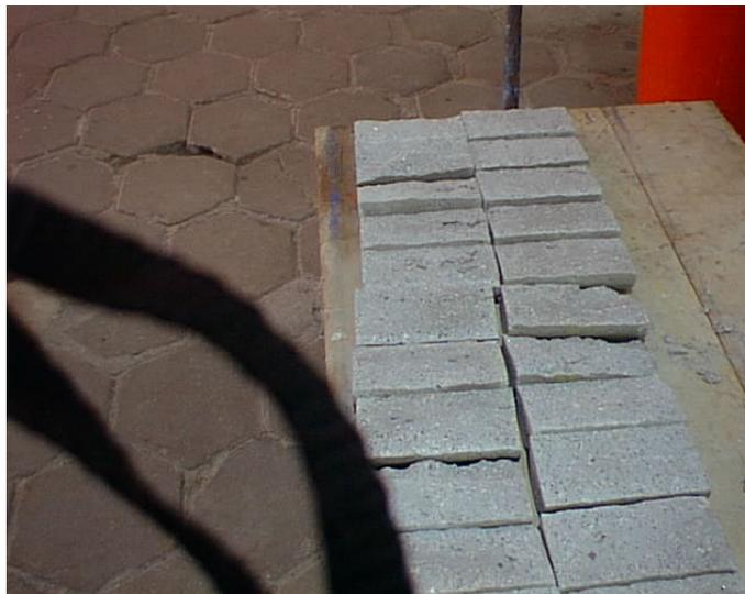
Figura 4.7 - Corpos de prova ensaiados por compressão diametral
