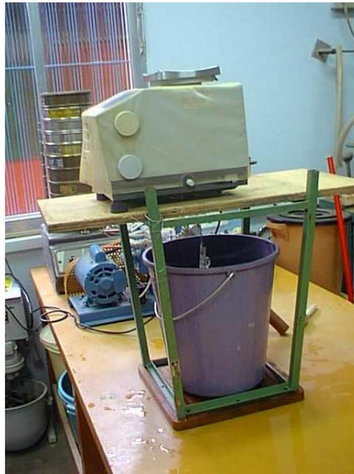
Figura 4.14 – Balança hidrostática para pesagem dos corpos de prova imersos.
