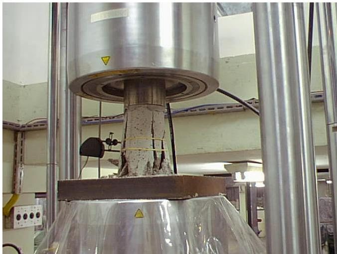
Figura 4.10 – Corpos de prova rompidos indevidamente por problemas no ensaio.
