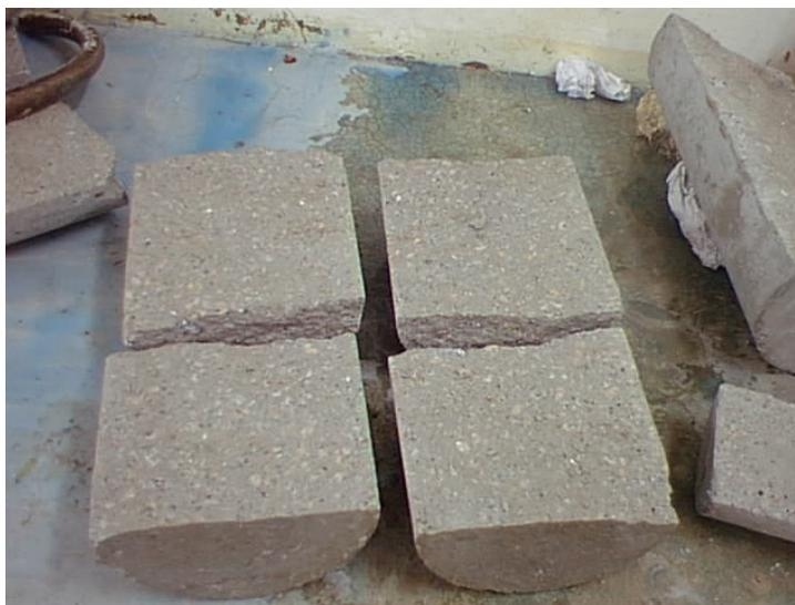
Figura 4.5 – Corpos de prova ensaiados à compressão diametral.
