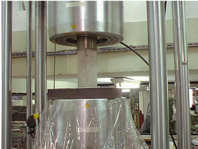
Figura 4.9 - Corpo de prova preparado para ensaio na máquina INSTRON
