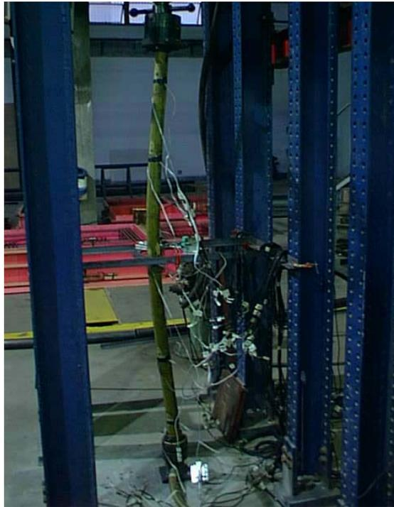
Figura B.9. Flambagem de elemento de 1800 mm de comprimento.
