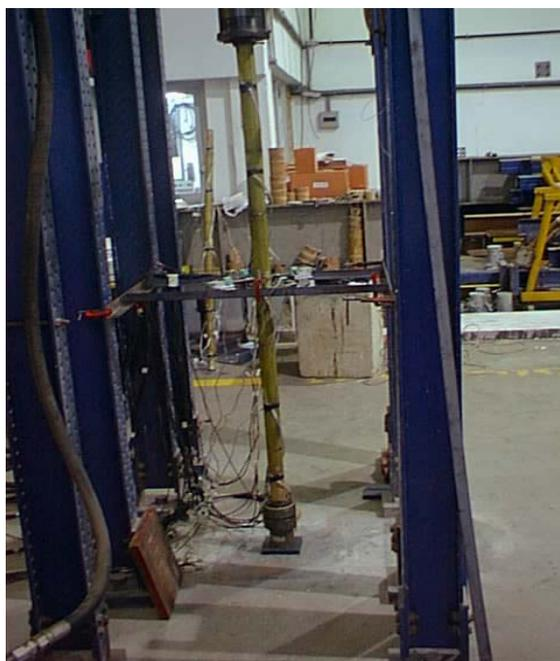
Figura B.10. Após retirada a carga o elemento volta a seu estado inicial.
