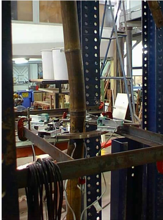
Figura B.5. Colocação dos strain gages na proximidade do nó.
