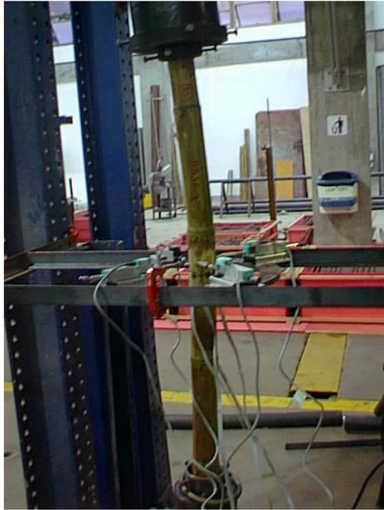
Figura B.3. Ensaio de flambagem de elemento de 800 mm de comprimento.
