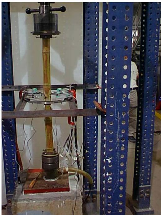
Figura B.1. Posicionamento do elemento na AMSLER.
