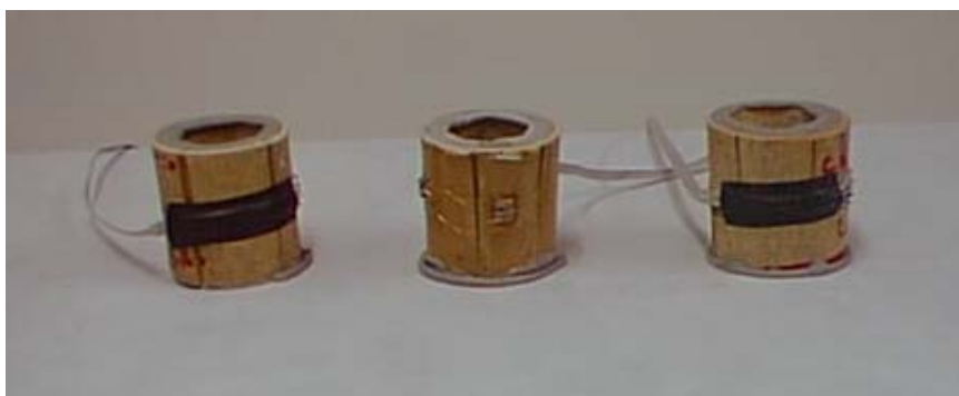
Figura 3.25. Ruptura de corpo de prova.
