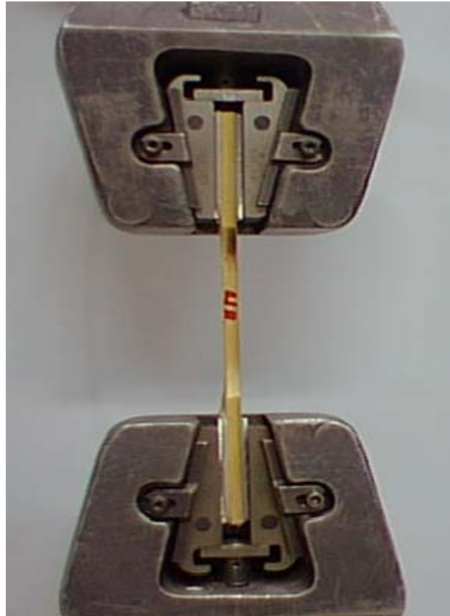
Figura 3.11. Colocação do corpo de prova na INSTRON 500.
