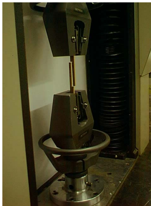
Figura 3.19. Ruptura do corpo de prova.
