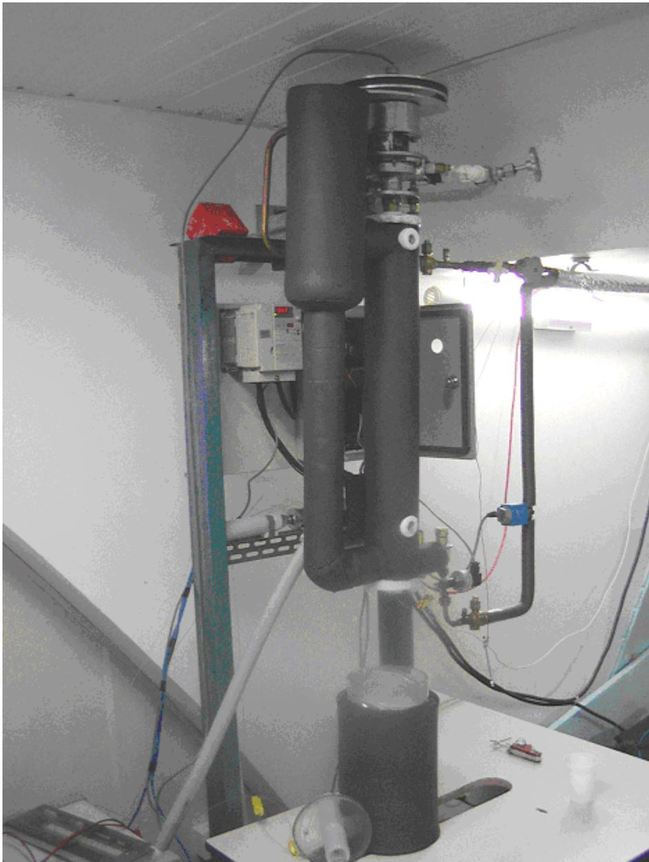
Figura 26 - Vista parcial do sistema gerador de pasta de gelo
