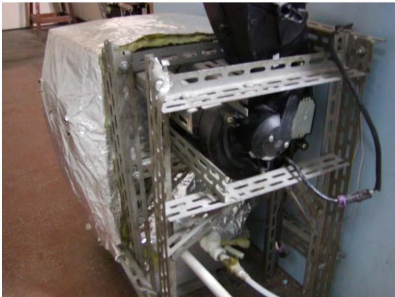
Figura 4.16- Conjunto umidificador - ventilador.
