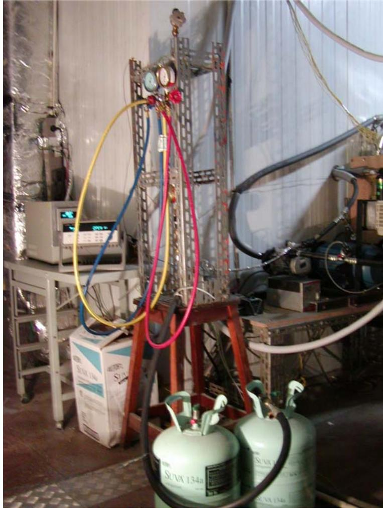
Figura 4.14- O Sistema de Carga de Gás.
