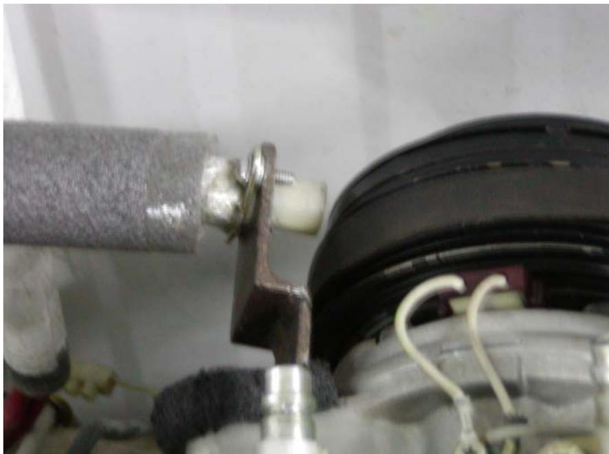
Figura 4.11- Posicionamento do Sensor Magnético no compressor.
