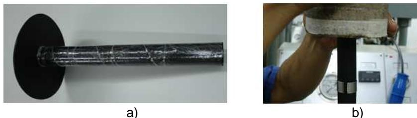
Figura 4.20 - Modos de instrumentação das deformações do cilindro vazado, a) membrana de viton instrumentada com fibra óptica e b) anel instrumentado com extensômetro elétrico.
