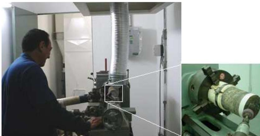
Figura 4.7 - Preparação de topo e base de CP em torno mecânico.
