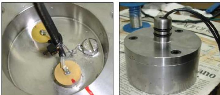
Figura 4.13 - Introdução de cristais piezoelétricos nos caps do topo e base.
