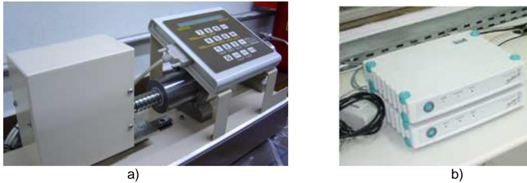
Figura 4.17 - a) ADVDPD e b) Sistema de aquisição Spider 8.
