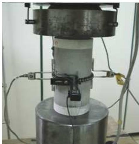
Figura 4.25 - CP de pasta de cimento instrumentado e preparado para iniciar ECU.
