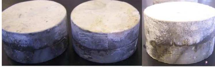
Figura 4.27 - CPs retirados da matriz após a cura.
