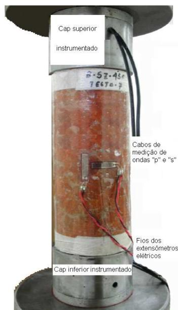
Figura 4.22 - CP de carnalita instrumentada preparado para o ECU (Fonte: IPT-SP).
