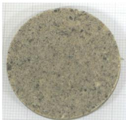
Figura 4.9 - Amostra de halita preparada para DRX.
