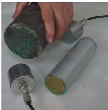
Figura 4.8 - Medição de velocidade compressional em CP de halita.
