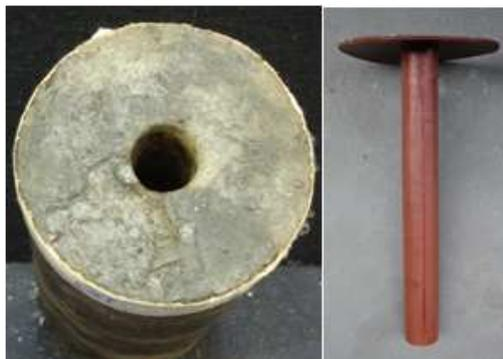
Figura 4.19 - Membrana de viton na parte interna do CP.
