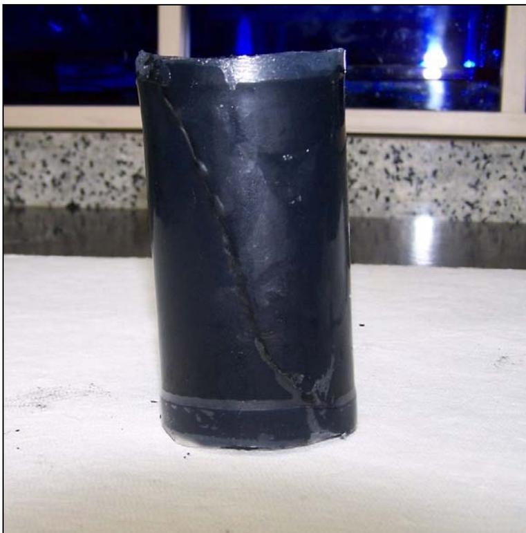
Figura 60 - Superfície de ruptura do CP 3 com tensão confinante de 5 MPa
