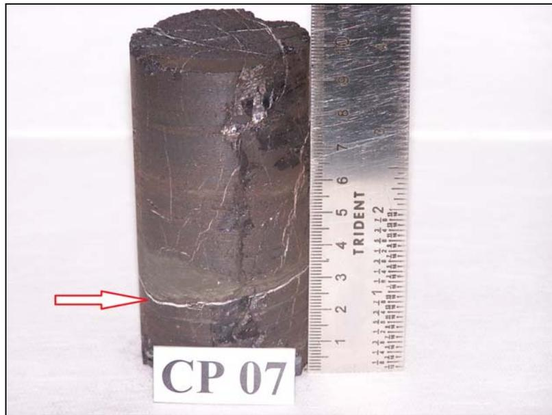
Figura 40 - Fratura no CP 7 onde o corpo de prova quebrou
