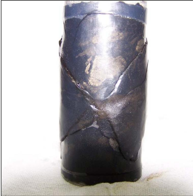
Figura 61 - Superfície de ruptura do CP1 com tensão confinante de 14 MPa
