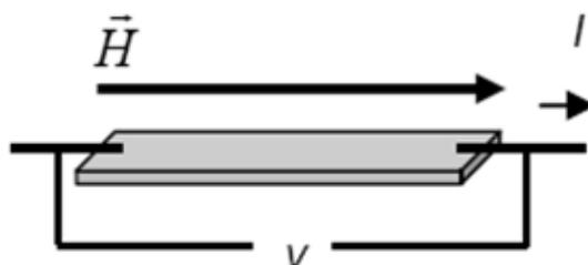
Figura 6 – Medição Típica do efeito LMI.
