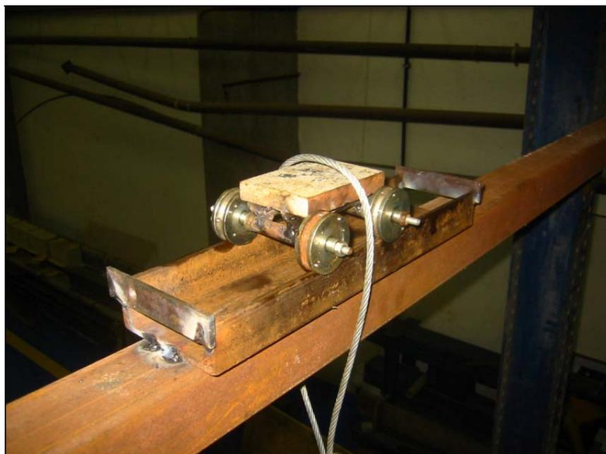
Figura 3.36 Apoio para sustentação da coluna no vão central
