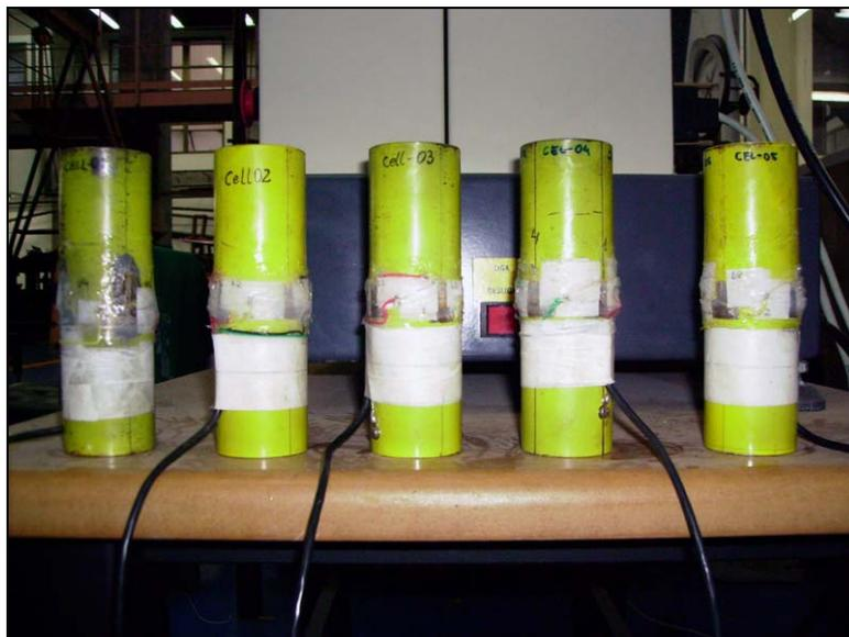
Figura 3.34 Segundo modelo de célula de carga.
