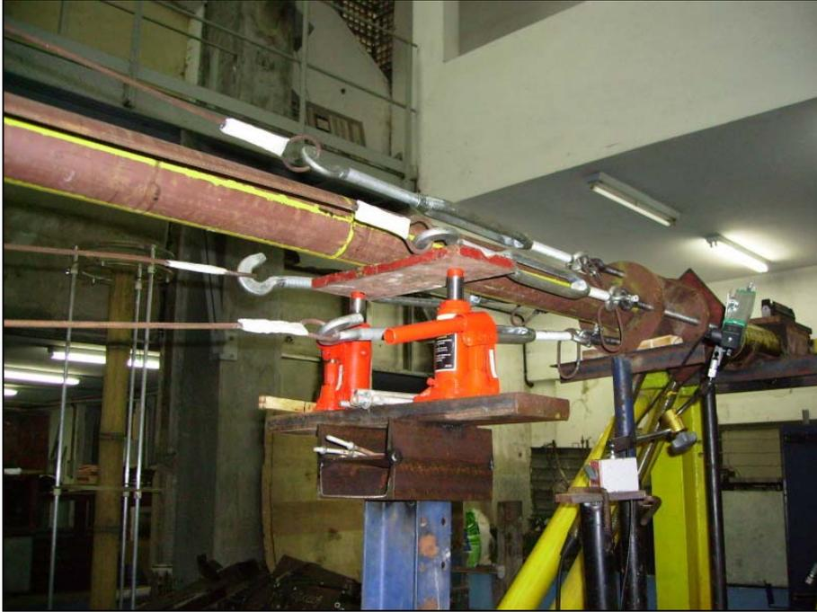
Figura 3.49 Travamento dos estais nas barras de ancoragem próximo ao macaco hidráulico.
