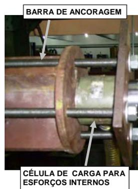
Figura 3.41 Ancoragem na extremidade da coluna próximo ao macaco hidráulico.
