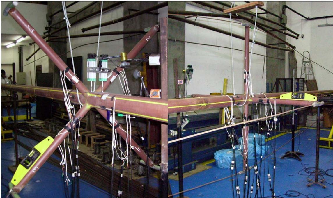
Figura 3.2 Modos de ensaios no laboratório – “modo x” e “modo +” respectivamente
