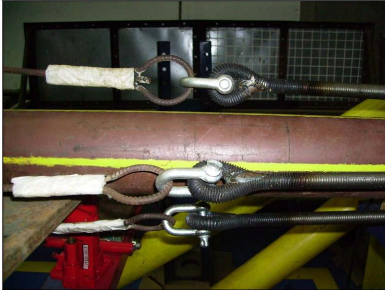
Figura 3.48 Travamento dos estais nas barras de ancoragem próximo as células de carga dos estais.
