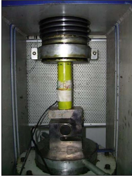
Figura 3.35 Calibração da célula de carga na prensa hidráulica
