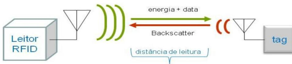
Figura 19: Sistema RFID passivo.
