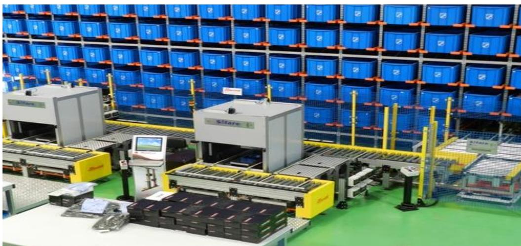
Figura 9: Depósito Central da FAB: caixas contendo fardas e túneis para leitura de RFID. Fonte: RFID Journal Brasil (2012b).
