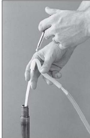
Figura 3.8: Amostragem de gases na zona vadosa/solo para análises de CO<sub>2</sub>, foto de Melo e Bressan.
