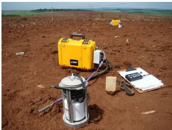
Figura 3.6: Câmara de fluxo que quantifica fluxos de  $\text{CO}_2$  do solo em uma área pré-determinada, foto de Melo e Bressan.
