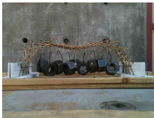
Figuras 117 e 118: arco com carga máxima e 7 cabos de suporte (117), arco com carga máxima e sem cabos de suporte para estabilização (118).
