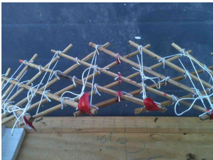
Figura 116: detalhe dos cabos de suporte transversais à treliça.
