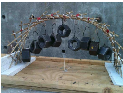
Figuras 117 e 118: arco com carga máxima e 7 cabos de suporte (117), arco com carga máxima e sem cabos de suporte para estabilização (118).
