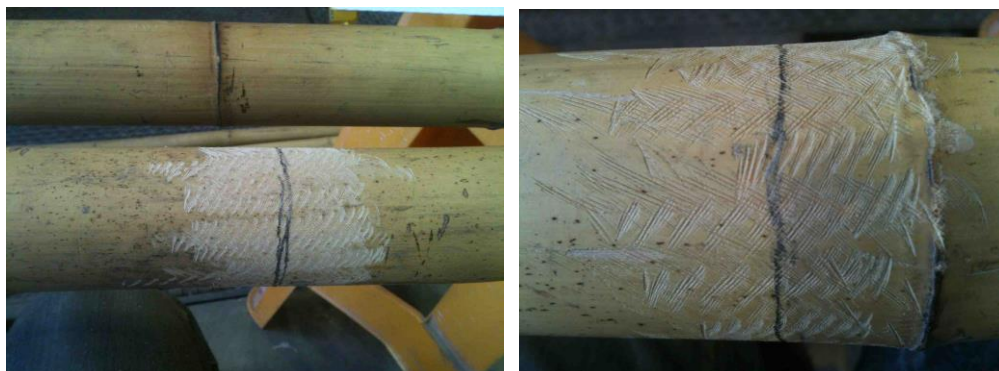
Figuras 123 e 124: Detalhe da rasura feita na superfície do colmo do bambu, com a marcação do lápis em cima.
