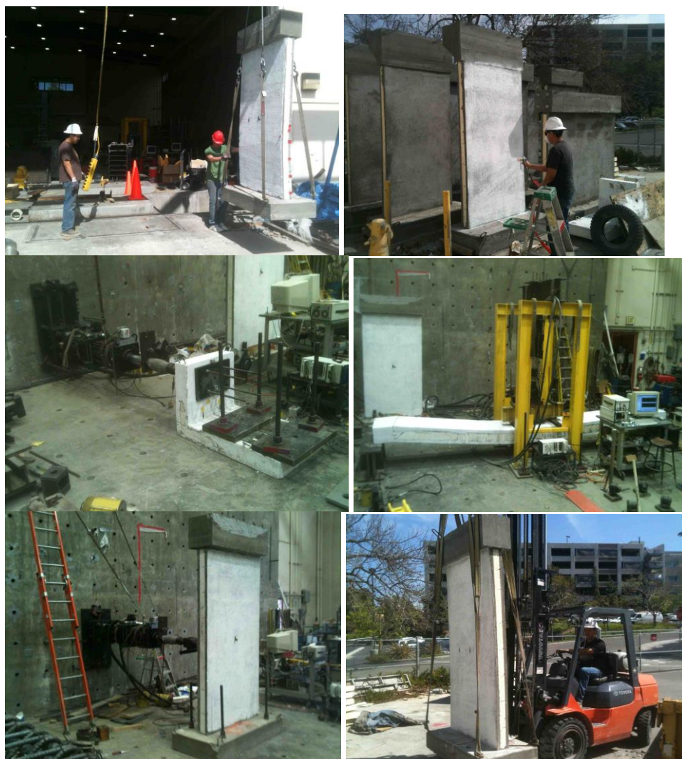
Figuras 101, 102, 103, 104, 105, 106: Alguns dos testes de estruturas realizados na assistência aos alunos de pós-graduação: transporte dos espécimes, preparação para o teste, descarte dos espécimes.
