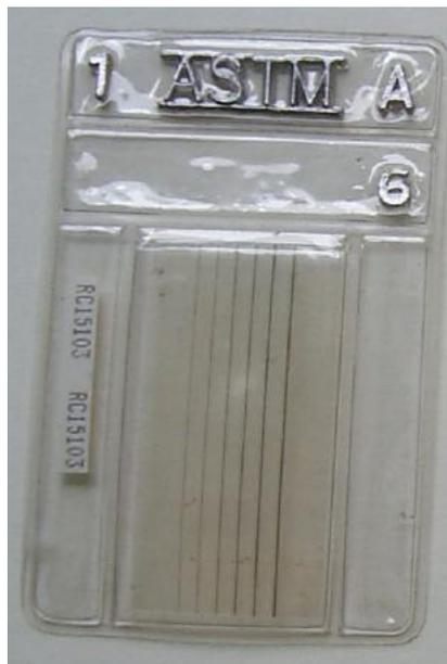
Figura 36 - IQI tipo fio (Norma ASTM) [25].
