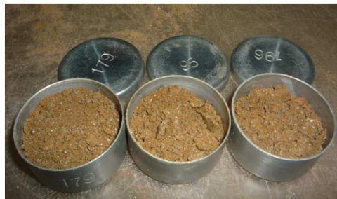
**Figura 3.13 – Capsulas com mistura de solo-fibra tirados do moldagem**
