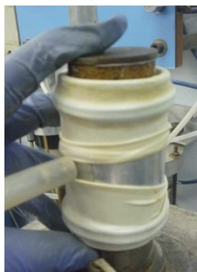
**Figura 3.18 – Colocação do papel filtro e a pedra porosa no topo do corpo-de-prova**
