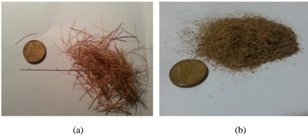
**Figura 3.6 – fibra de coco verde cortada utilizada nos corpos-de-prova – (a) cortada; (b) moída.**
