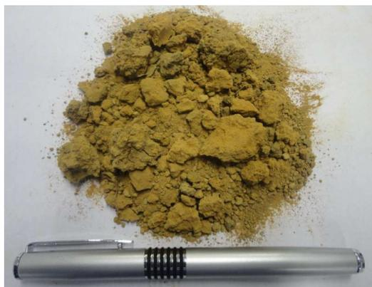
**Figura 3.2 – Argila utilizada - solo argiloso coluvionar.**
