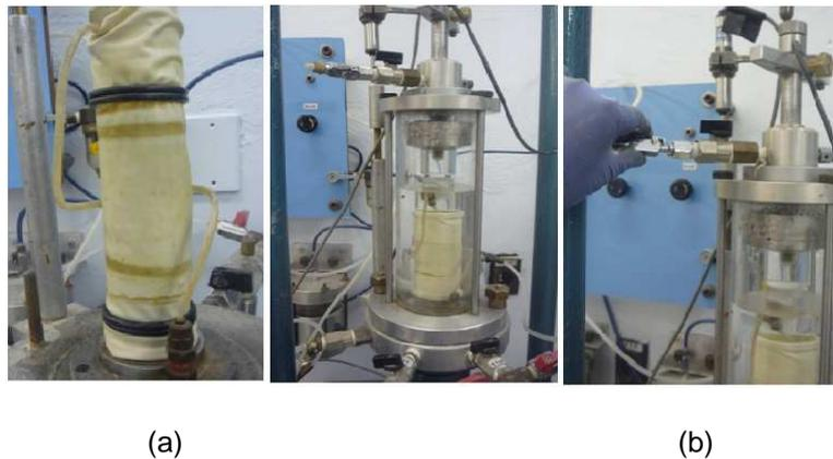
**Figura 3.19 – (a) Fixação da membrana ao corpo de prova com os o-rings; (b) Preenchimento da câmara triaxial com água; (c) Colocação da conexão de pressão confinante.**
