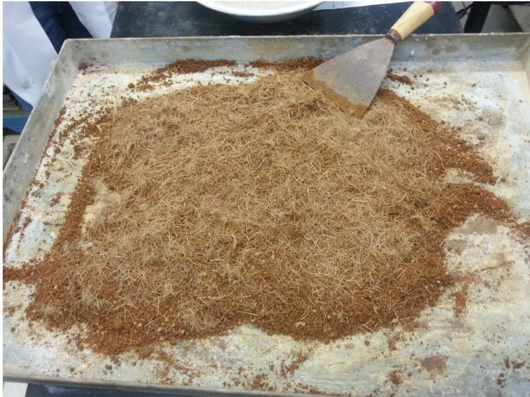
**Figura 3.7 – Processo de mistura do solo e da fibra**
