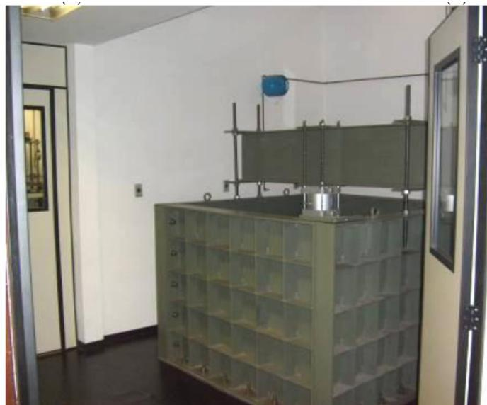
Figura 2.25 – Caixa de ensaios utilizada por Kakuda, 2010.
