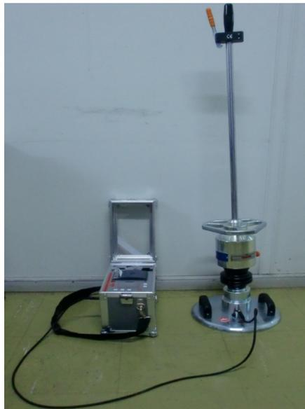
Figura 2.9– Equipamento Light Weight Deflectometer (LWD) do IME, usado neste estudo.
