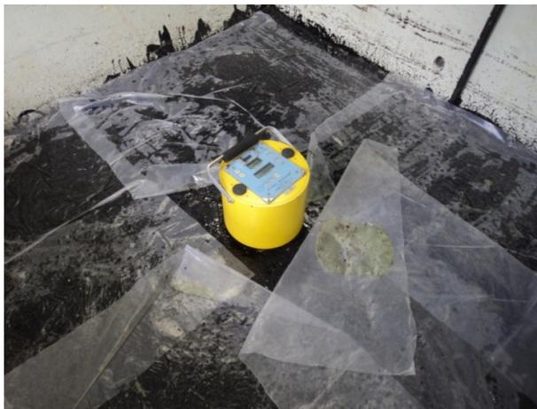
Figura 2.7 - Equipamento GeoGauge H-4140 da Humbolt no local do presente estudo sobre a base imprimada.
