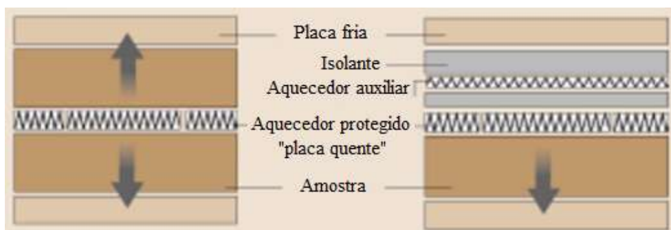
Figura 4 – Princípio do método da placa quente protegida. Aparato de duas amostras à esquerda e aparato de amostra única à direita (Czichos et al. , 2006)
