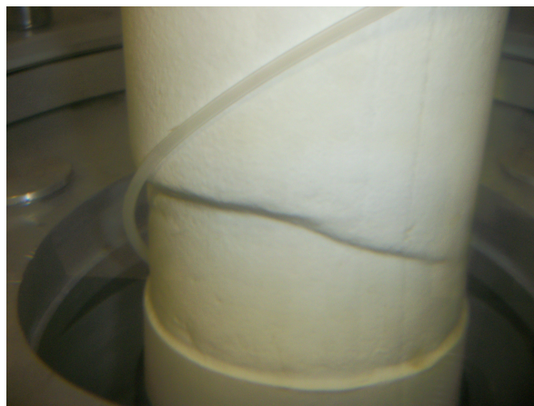
Figura 4.4 – Mecanismo de deformação da amostra da mistura areia-fibra submetida a ensaios de extensão.
