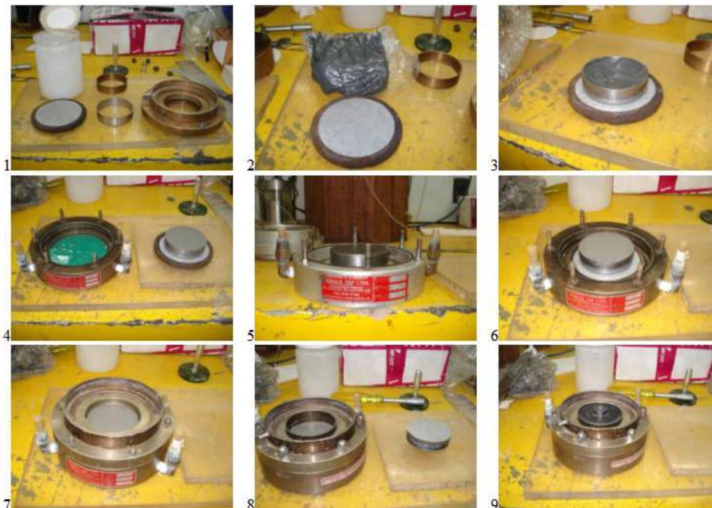
*Figura 4.10 – Sequência de moldagem dos corpos de prova amolgados.*
