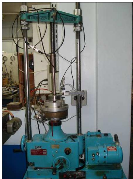
*Figura 4.6 – Prensa para ensaios de adensamento do tipo CRS – LGMA (PUC-Rio).*
