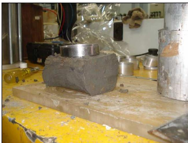
*Figura 4.9 – Detalhes do procedimento de moldagem de um CP na direção vertical.*
