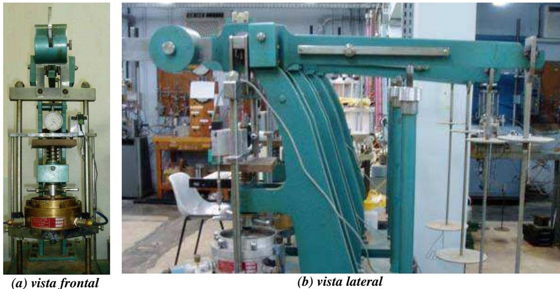
*Figura 4.5 – Prensa de adensamento do tipo Bishop – LGMA (PUC-Rio).*
