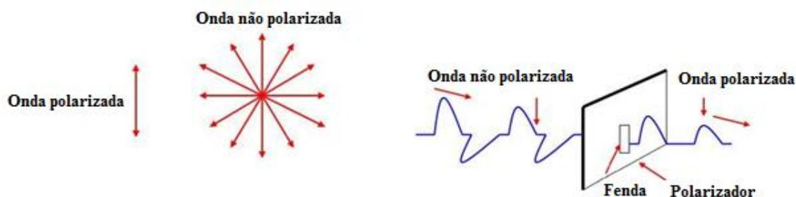
Figura 6 – Exemplo de luz não polarizada incidindo sobre uma lâmina polarizadora.
