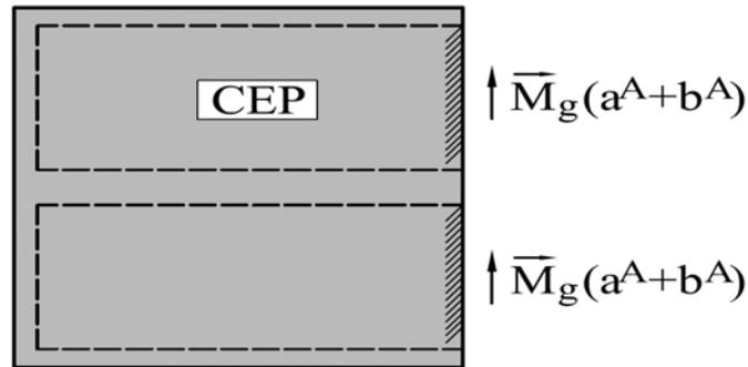
Figura 3.4 – Densidade de corrente magnética induzida sobre a abertura.
