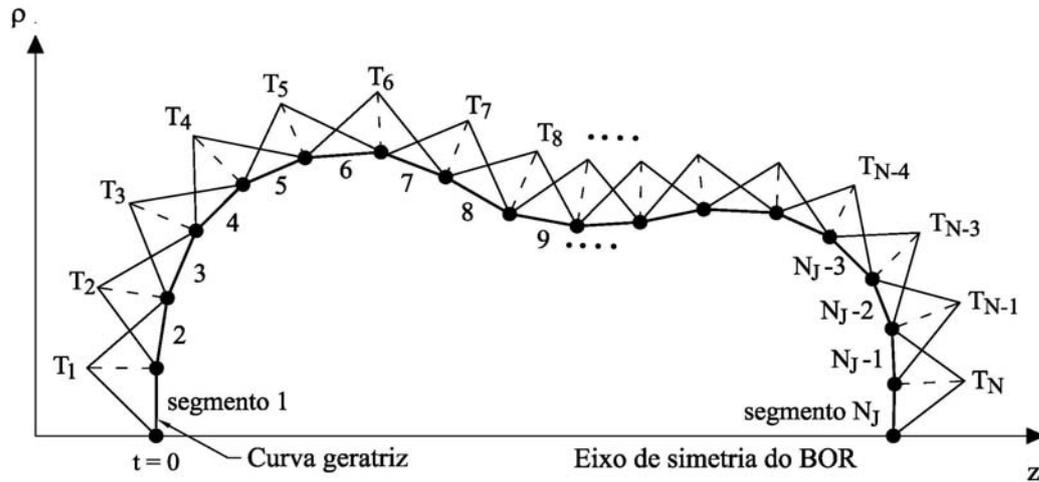
Figura 3.6 – Representação das funções triangulares ao longo da curva geratriz.
