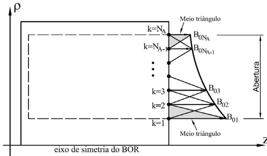
Figura 3.8 – Representação das funções triangulares associadas a corrente superficial equivalente magnética ao longo da abertura e dos coeficientes da expansão modal  $B_{lk}$  para o modo TEM.
