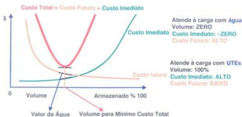
Figura 2.4 - Minimização do Custo de Operação de um Sistema Hidrotérmico
