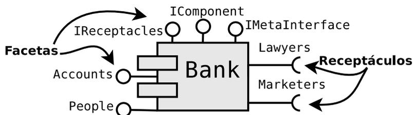
Figura 3.1: Modelo de componentes SCS (fonte [2])
