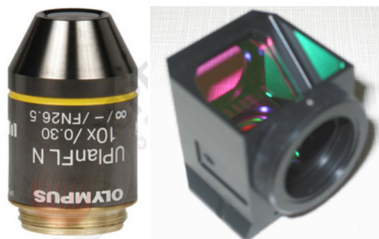
Figura 4.4: Objetiva Olympus 10x0.30 (esquerda) e cubo de filtro (direita).
