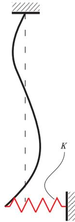
Figura 4.1: Cabo fixo com mola na extremidade
