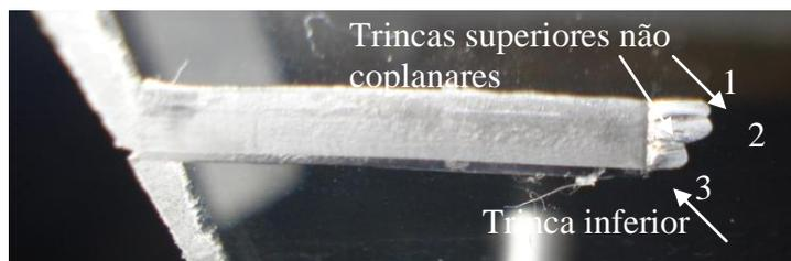
Figura 2.17 – Pré-Coalescimento, crescimento semi- elíptico de múltiplas trincas bidimensionais localizadas no meio de um entalhe, corpo de prova ESE(T) (w,h,t) = (65mm, 2970mm, 10mm), policarbonato (Lab. Fadiga PUC-Rio, 2010)
