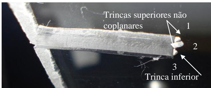
Figura 2.16 – Pré-Coalescimento, crescimento semi- elíptico de múltiplas trincas bidimensionais localizadas no meio de um entalhe, corpo de prova ESE(T) (w,h,t) = (65mm, 2970mm, 10mm), policarbonato (Lab. Fadiga PUC-Rio, 2010)
