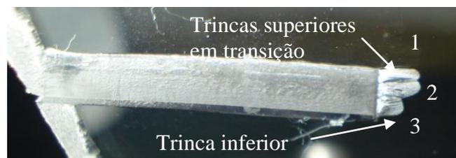
Figura 2.18 – Coalescimento, crescimento semi-elíptico de múltiplas trincas bidimensionais localizadas no meio de um entalhe, corpo de prova ESE(T) (w,h,t) = (65mm, 2970mm, 10mm), policarbonato (Lab. Fadiga PUC-Rio, 2010)
