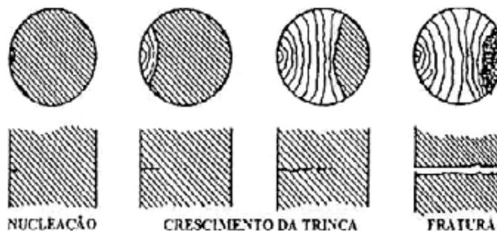
Figura 2.3: Representação esquemática da fratura por fadiga
