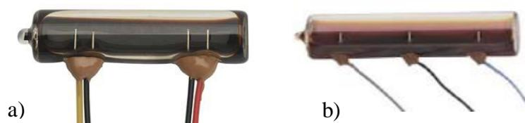
Figura 3.2 – Vista de eletrônives. a) eletrônível com quatro pinos (eletrodos) b) eletrônível com três pinos. ([www.frederickson.com](http://www.frederickson.com)).
