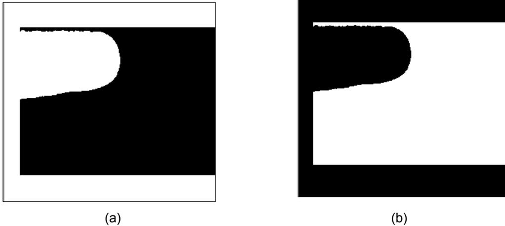
Figura 5.6 – Resultado após binarização, delimitação da região de presença de líquido, antes (a) e depois da inversão dos valores da região da bolha e do líquido (b).
