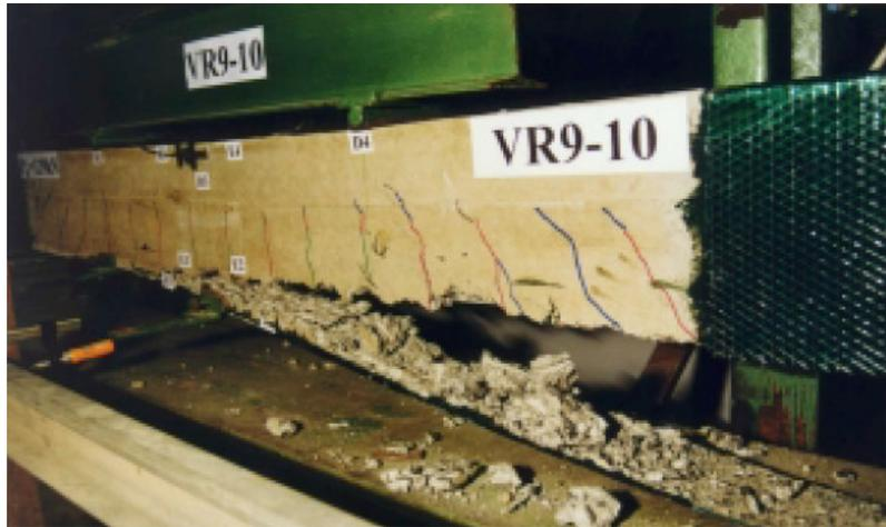
Figura 2.4 – Delaminação do cobrimento de concreto (BEBER et al, 2000).
