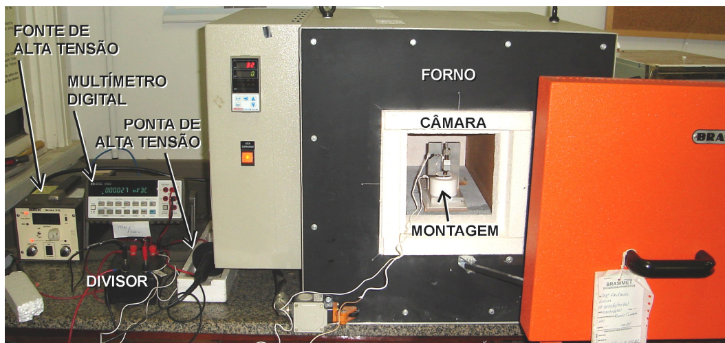
Figura 5. Foto do arranjo experimental utilizado nos procedimentos de polarização eletro-térmica.
