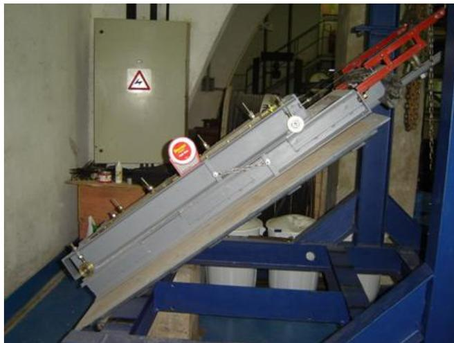
Figura 32 - Ensaio de rampa após a ruptura
