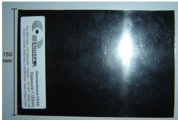
Figura 26 - Amostra representativa da Geomembrana (GM) ensaiada
