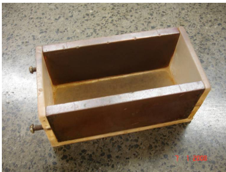
Figura 6.62 – Ensaio para a determinação da resistência elétrica em amostras deformadas. “Soil Box”.
