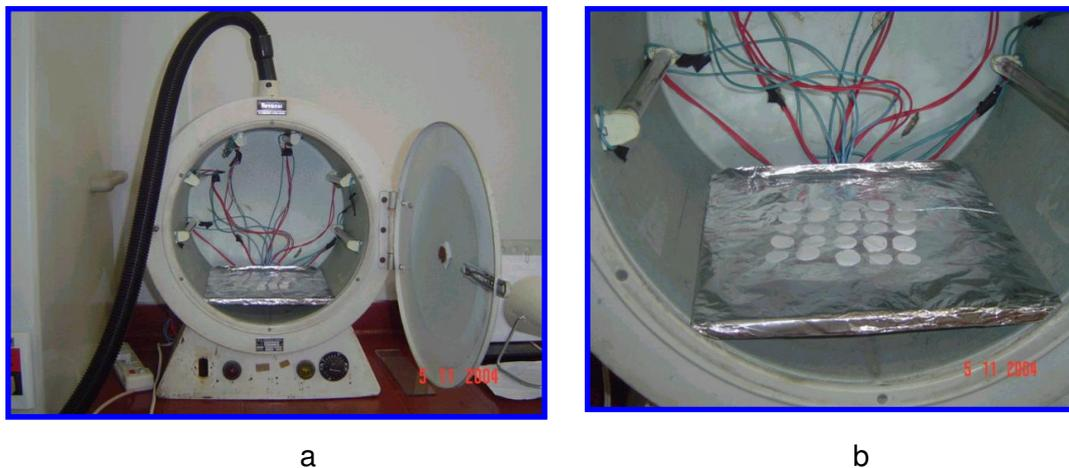
Figura 6: (a) Reator fotoquímico e (b) detalhe dos papéis sendo irradiados.
