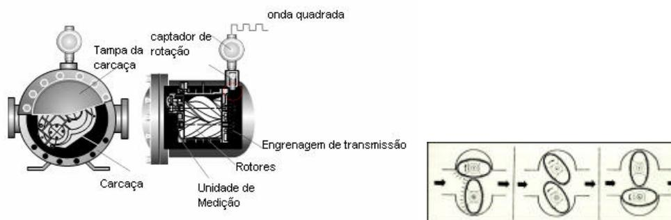
**Figura 7 – Medidor de Engrenagens Ovais - exemplo de medidor de deslocamento positivo e princípio de funcionamento.**
